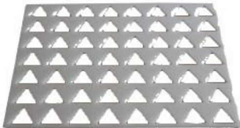
Plaque de moulage de 600 x 490 Epaisseur : 15 mm, 56 trous triangulaire 60 x 60 x 60 Poids du fromage : environ 20 à 25 grs
